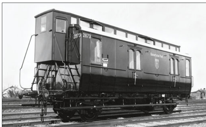
Bahnpostwagen Schwerin 2873 Post-b/8,5; Wagenkasten grün über alles (Werkfoto 1911 Mombach)
