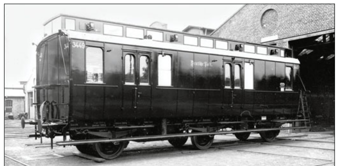
Bahnpostwagen Baden 3449 Post3-a/10; Wagenkasten grün, Deckschienen schwarz; bemerkenswert ist auch die kurzlebige Eigentumsanschrift in Frakturbuchstaben (Werkfoto 1922 Deutz)
