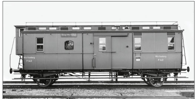
Bahnpostwagen Württemberg Post 142; Wagenkasten dunkelgrün, Einfassungen schwarz (Werkfoto 1905 Esslingen)
