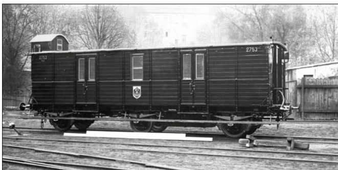
Bahnpostwagen Köln 2753 Post3-c/10; Wagenkasten grün über alles (Werkfoto 1909 Görlitz)
