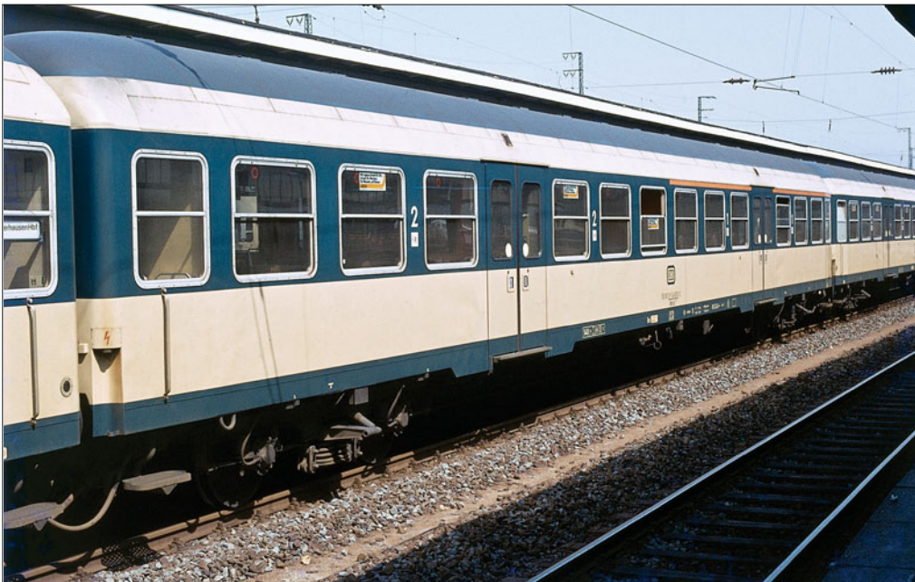
Nahverkehrswagen DB 50 80 31-34 600-2 ABnrzb 708 versuchsweise mit umgekehrter Anordnung des regulären elfenbein/ozeanblauen Anstrichs am Wagenkasten, Dachtonsur umbragrau, Vouten elfenbein, Langträgerverkleidung ozeanblau (Foto Oberhausen 1979 Werner Ballon)
