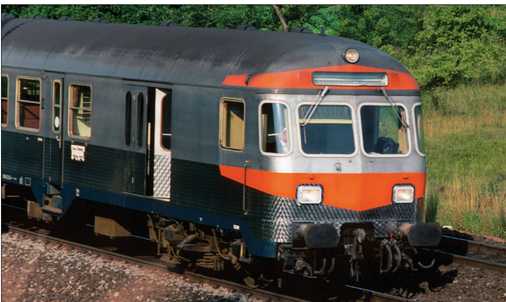
Nahverkehrssteuerwagen DB BDnrzf 740 mit stirnseitigen Kontrastflächen in reinorange (Foto Rottendorf 1978 Günter Tscharn)
