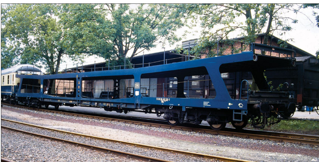
Schnellzuggepäckwagen für die Mitnahme von Kraftfahrzeugen DB 51 80 98-80 139-3 DDm 915; Wagenaufbau fernblau, Rahmen graubraun (Foto 1988 Paderborn)
