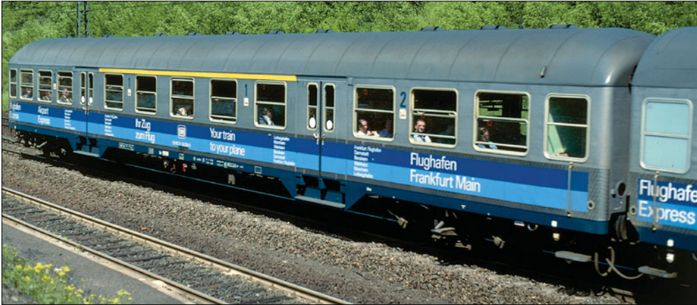
Nahverkehrswagen ABnb 703; Dach umbragrau, Wagenkasten oben blank, unten dunkel- bzw. hellblau, Langträgerverkleidung ozeanblau (Foto Darmstadt 1979 Hans Ulrich Diener)
