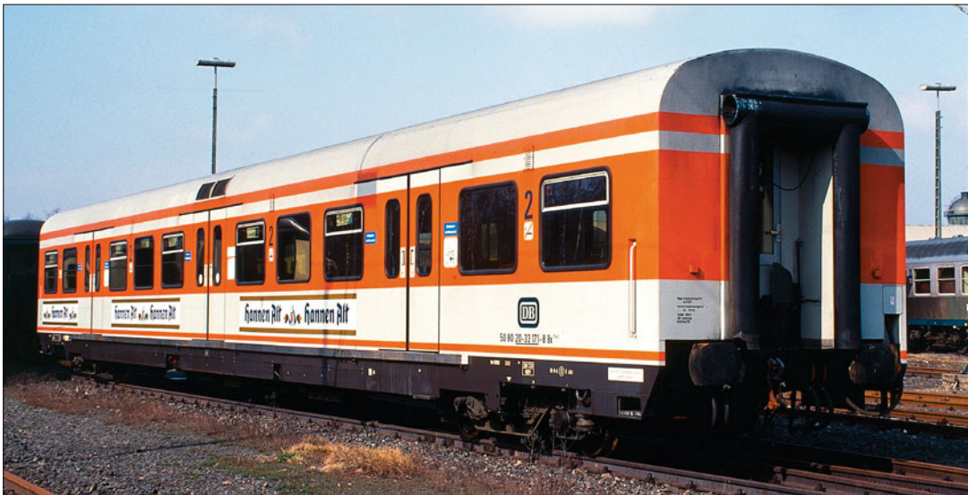
S-Bahn-Wagen DB 50 80 20-33 171-8 Bx 794.1; Dach, Zierstreifen oben, Wagenkasten unter den Fenstern kieselgrau, Fensterband und Zierstreifen unten reinorange, Langträgerverkleidung, Schürzen, Untergestell graubraun (Foto Oppum 1992 Werner Ballon)
