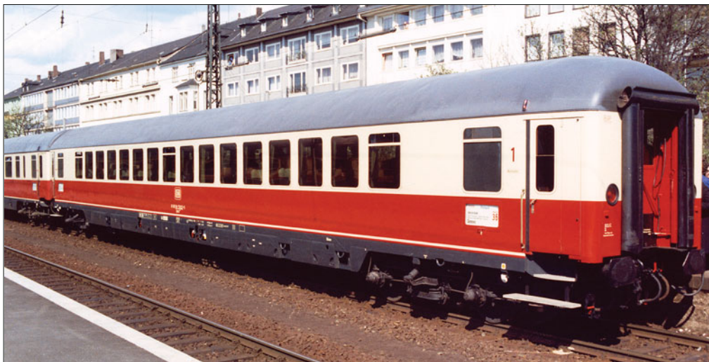
Schnellzugwagen DB 61 80 18-73 022-5 Apmz 121; Dach umbragrau, Wa- genkasten elfenbein und purpurrot, Zierstreifen elfen- bein, Langträgerverkleidung und Schürzen schwarzgrau (Foto 1977 Gerhard Krauth)
