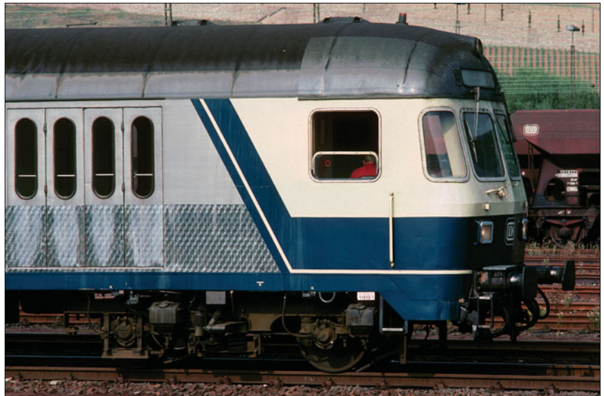
Nahverkehrssteuerwagen DB BDnrzf 740 zur Kontrasterhöhung mit Anstrich in elfenbein/ ozeanblau im Bereich des Führerstandes (Foto Bingerbrück 1990 Günter Tscharn)
