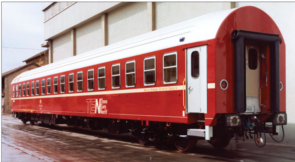
Schlafwagen DB 71 80 75- 70 411-1 WLABmz 166; Wagenkasten und Langträ- gerverkleidung purpurrot, Zierstreifen elfenbein, Dach, Türen und Fensterrahmen aluminiumfarbig (Werkfoto 1975 Schlieren)
