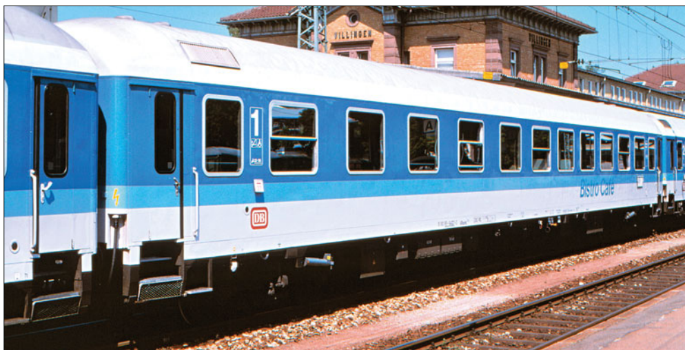
Interregio-Wagen DB 51 80 85-94 021-2ARKimbz 262.2; Dach fenster- und lichtgrau, Wagenkasten und Langträgerverkleidung lichtgrau, Fensterband fernblau, Begleistreifen pastellblau, Drehgestelle graubraun (Foto Villingen 1990 Rolf Köstner)
