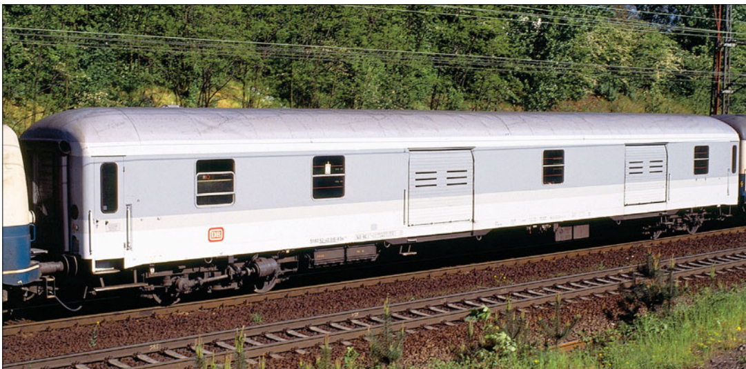
Schnellzugwagen DB 51 80 92-40 016-8 Dm 902; Dach fenster- und lichtgrau, Wagenkasten verkehrsgrau A, achtagrau und lichtgrau, Langträgerverkleidung lichtgrau, Rahmen graubraun (Foto Darmstadt 1990 Hans Ulrich Diener)
